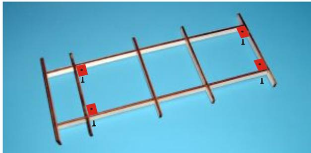
Am Wagenboden selber werden Sperrholzreste in 3 mm Stärke an der Unterseite so angeklebt, dass diese genau den Leisten an Fahrwerk gegenüberliegen. So wird vermieden, dass beim Zusammenschrauben von Aufbau und Fahrwerk die Spitzen der Schrauben durch den Wagenboden dringen.
