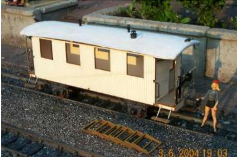
Das Dach ist nur lose aufgelegt, da die Inneneinrichtung fehlt. Die Fenster werden erst nach dem Farbauftrag montiert, vorher die Verglasung nicht vergessen.
