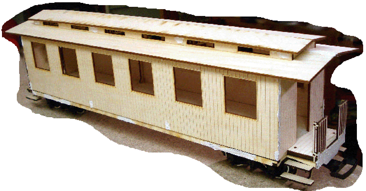
Waggon im montierten Zustand mit erster Grobspachtelung
