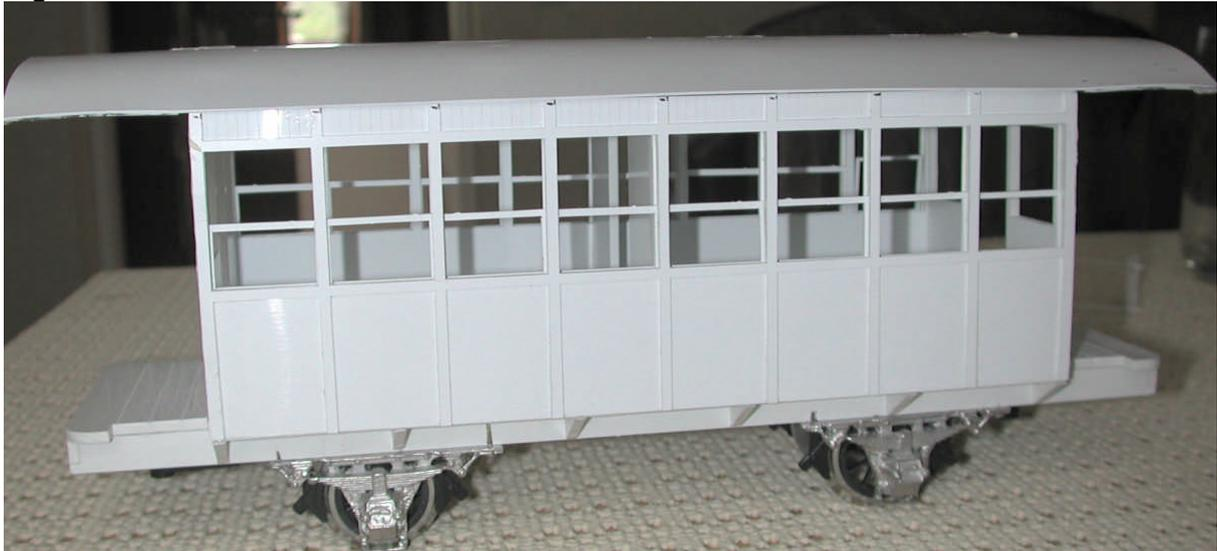
Der Wagenkasten wird mit dem Boden verschraubt – NICHT geklebt! Dazu genügen mittig pro Wagenseite eine Schraube, die von unten durch den Boden in den Wagenkasten führt (da, wo sich die Abteilwand befindet). Ebenso das Dach – die Schrauben werden an den Stirnseiten ganz nahe des Dachs angebracht (sind somit fast unsichtbar).
